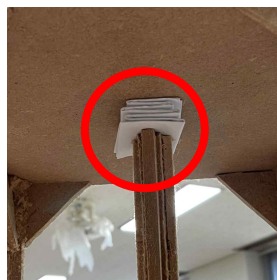
4층 바닥면과 기둥B의 윗부분을 종이 댐퍼로 연결하여 기둥B에 가해지는 하중과 충격을 완화
